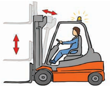
La inclinación del mástil y de las horquillas, así como verificar que se desplazan lentamente
