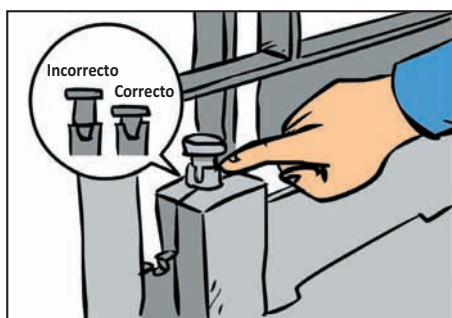
Las sujeciones (el pestillo) de los topes
