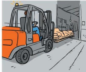
Carretilla empujando una pieza con horquilla elevada
