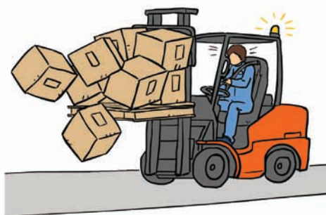
Riesgo: carga sin sujeción
