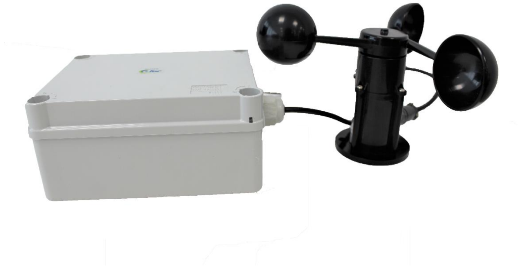
Ilustración 6.8. Dispositivo construido para evaluar el riesgo de estrés térmico por frío.
