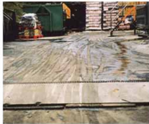
Zonas de paso de carretillas elevadoras con riesgo por acumulación de materiales y ausencia de fijación de las protecciones en el suelo
