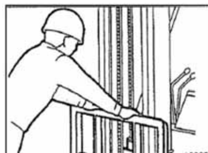
El respaldo (deformación, grietas...)
